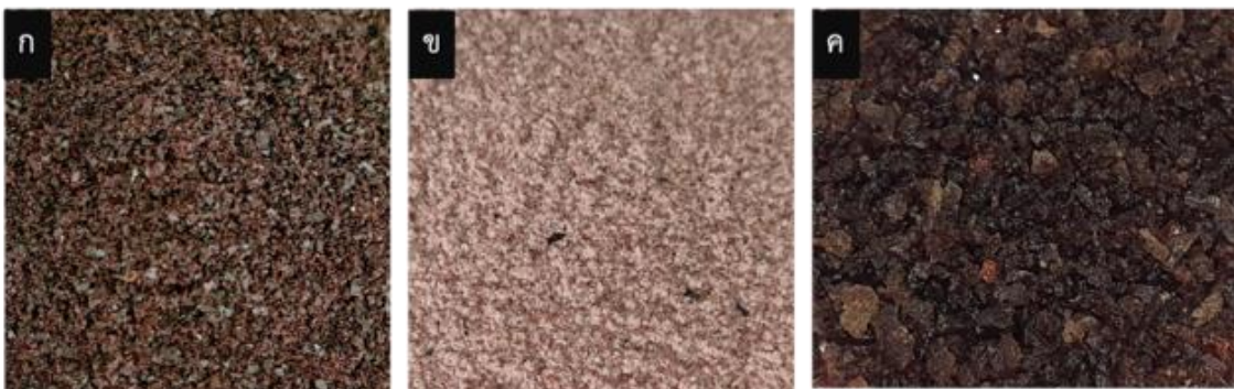
ภาพประกอบ 6 ลักษณะทางกายภาพของผงแอนโทไซยานินที่ไม่เติมสารทำให้แห้ง (ก) เติมสารทำให้แห้งมอลโตสเตรกตริน (ข) และเติมโซเดียมอัลจิเนต (ค)
