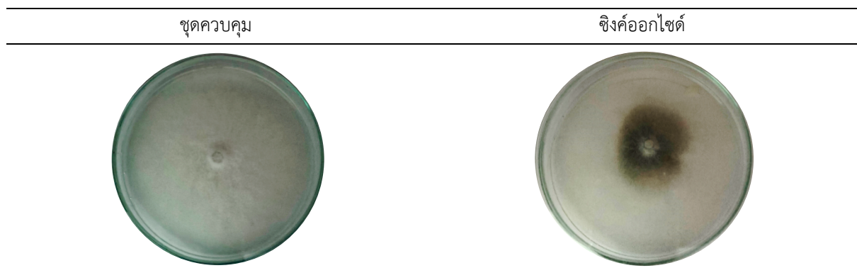
ตารางที่ 2 ผลการทดสอบประสิทธิภาพการยับยั้งเชื้อราก่อโรคราน้ำค้างของซิงค์ออกไซด์เผาแคลไซน์ที่อุณหภูมิ 700 องศาเซลเซียส ผสมกับสารสกัดจาก ขิง ข่า และไพล ที่อัตราส่วน 0:1 และ 1:1
