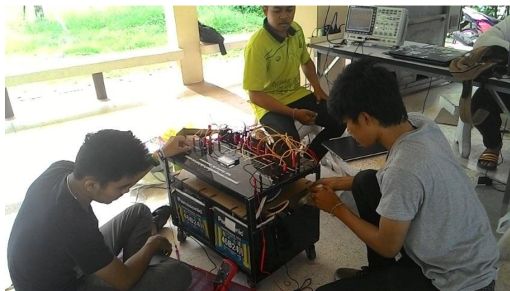
ภาพที่ 3.11 การทดสอบเครื่องกำเนิดไฟฟ้ากระแสตรงแบบไม่มีโหลด
