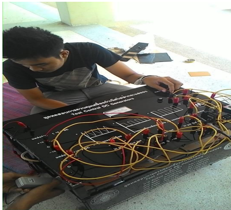
ภาพที่ 3.10 การทดสอบความเร็วรอบของมอเตอร์
