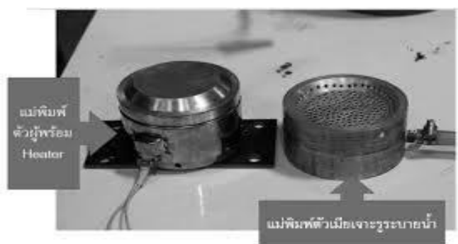
ภาพที่ 2.13 ชุดแม่พิมพ์สำหรับการขึ้นรูปถ้วยขนาด 4 นิ้ว (ที่มา : ดล จันทรลักษณ์. 2562)
