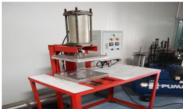
ภาพที่ 2.12 เครื่องอัดขึ้นรูปบรรจุภัณฑ์ (ที่มา : คมสัน มาลีสี. 2562)
