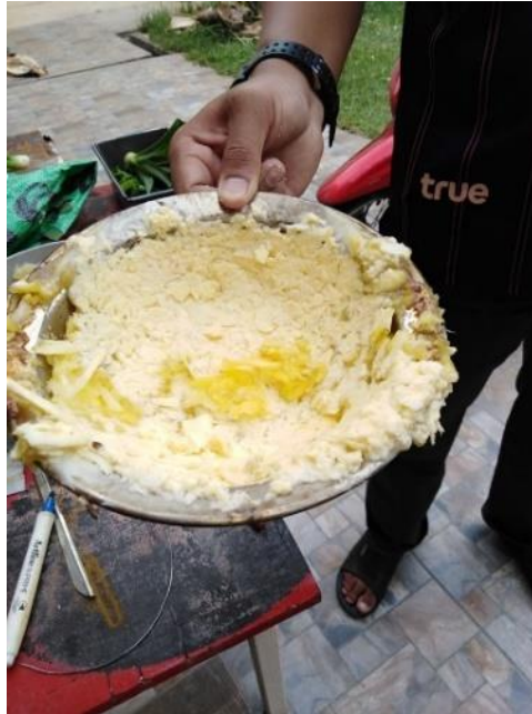
ภาพที่ ก.3 ไม่สามารถขึ้นรูปได้เพราะ ตัวมันสำปะหลังโดนความร้อนก็จะละลายติดกับตัวแม่พิมพ์
