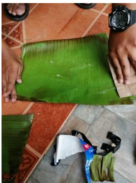
ภาพที่ ข.6 นำมาทับกัน 3-4 แผ่น ทาด้วยกาวที่ทำจากแป้งข้าวเหนียว
