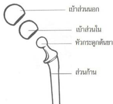
ภาพที่ 1.2 ส่วนประกอบของข้อตะโพกเทียมชนิด Bipolar
