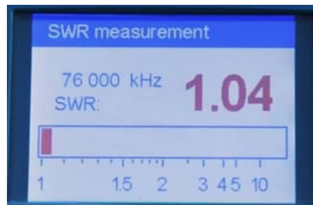
ภาพที่ 9 การวัดค่า SWR ของสายอากาศแบบ J-Pole ที่ความถี่ 76.00 MHz
