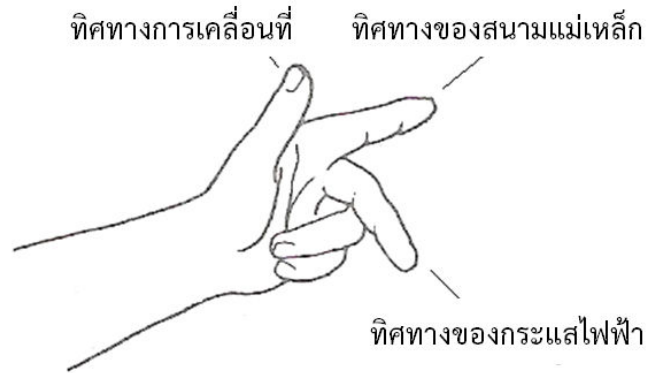
ภาพที่ 1.5 การใช้กฎของมือซ้าย อธิบายกฎของเฟลมมิ่ง ที่มา : ชัยวัฒน์ ลี้มพรจิตรวิไล (2552 : 14)
