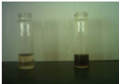
ภาพ 7 การพิสูจน์เอกลักษณ์ของสารที่ได้จากการกลั่นโดยHydroxamic Acid Test
