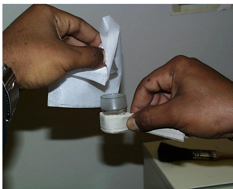
ภาพประกอบ 2.25 การใช้คีมหรือแถบกระดาษจับขวดชั่ง
