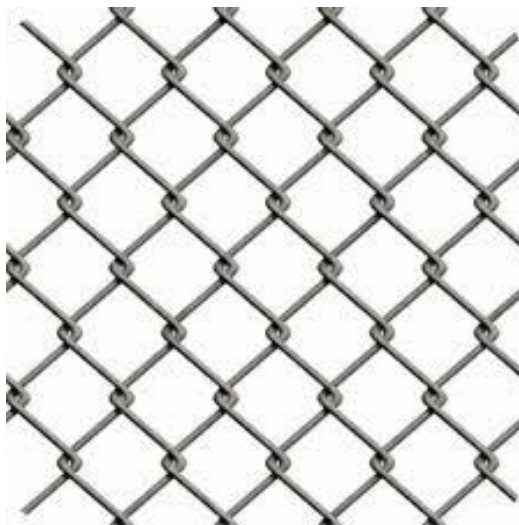
ภาพที่ 4.24 ตาข่ายเหล็กเหลื่อม
