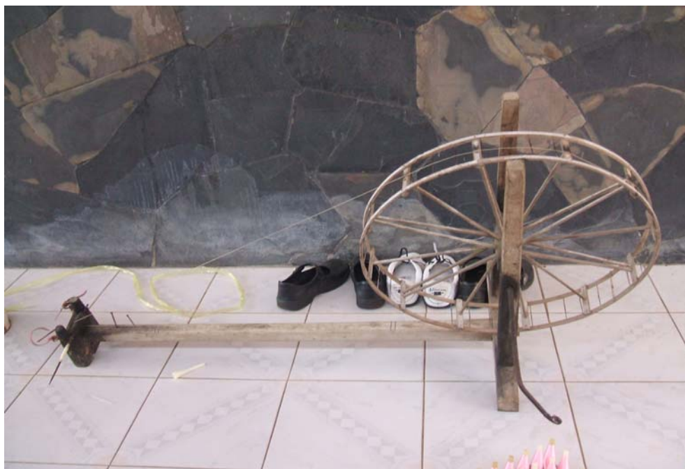
ภาพประกอบ 28 ไน หรือระหัด ใช้สำหรับกรอเส้นไหมเข้าหลอดเส้นพุ่ง ที่มา : ผู้วิจัย 14 มิถุนายน 2554
