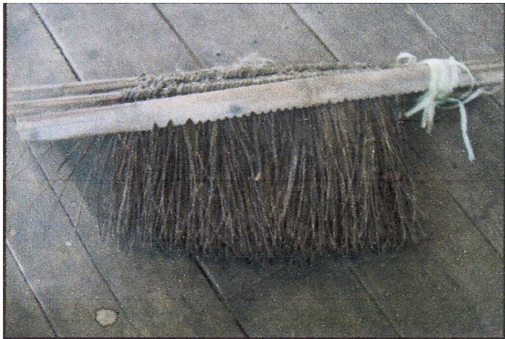
ภาพประกอบ 41 แปรง หรือแปรงเซ็ดเมาะ สำหรับหวีไหมเส้นยืน ที่มา : ผู้วิจัย 30 มิถุนายน 2554
