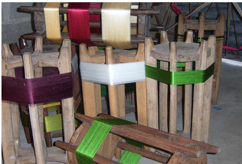
ภาพประกอบ 25 อักที่ใช้สำหรับปั่นเส้นไหมหลังจากสาวไหมเส้น เป็นการจัดระเบียบเส้นไหม ที่มา : ผู้วิจัย 14 มิถุนายน 2554
