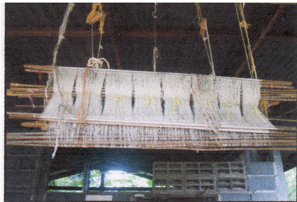
ภาพประกอบ 33 ฟืมทอผ้าไหมและตะกอบทอผ้าไหม
