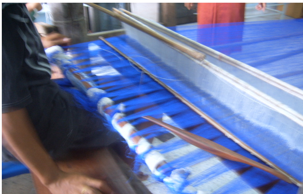
ภาพประกอบ 40 การมัดไหมเส้นยืนเข้ากับไม้พนักก่อนเริ่มทอผ้าไหม ที่มา : ผู้วิจัย 30 มิถุนายน 2554
