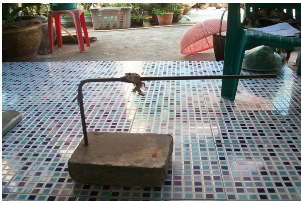
ภาพประกอบ 26 ฐานอักสำหรับปั่นเส้นไหมเข้าอักเพื่อจัดระเบียบเส้นไหม ที่มา : ผู้วิจัย 14 มิถุนายน 2554
