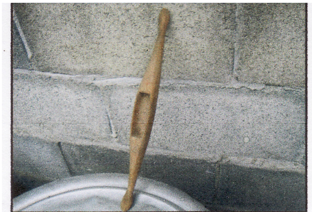
ภาพประกอบ 29 กระสวย หรือกระชวย ใช้ใส่หลอดด้ายเส้นพุ่ง ที่มา : ผู้วิจัย 14 มิถุนายน 2554
