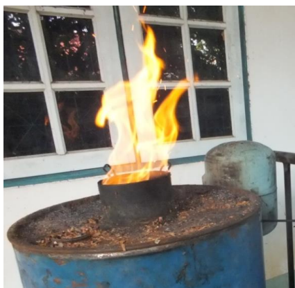
ภาพที่ 3.53 ภาพแสดงการตรวจเช็คแก๊สที่ปากห้องเผาไหม้ชั้นใน
