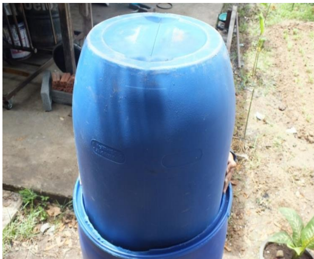
ภาพที่ 3.23 การสวมถังขนาด 200 ลิตร และ 150 ลิตร เข้าด้วยกัน
