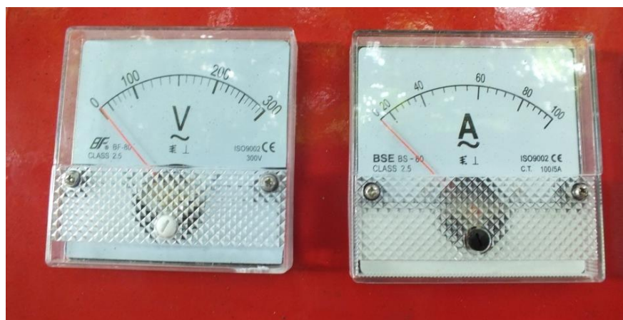
ภาพที่ 3.37 แสดงการติดตั้งอุปกรณ์ที่ใช้ตรวจวัดไฟฟ้ากระแสสลับ
