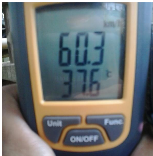
ภาพที่ 3.49 ภาพแสดงการปรับระดับปริมาณแรงลมระดับที่ 3
