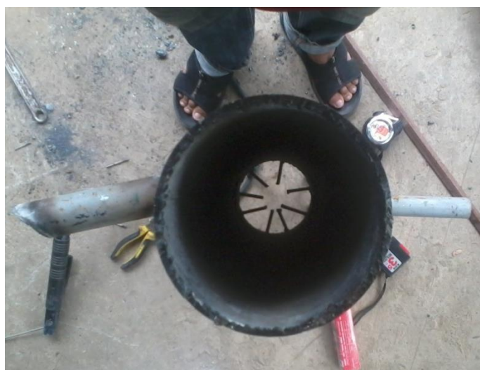
ภาพที่ 3.16 การต่อท่อขนาด 3.81 เซนติเมตร เข้ากับห้องเผาชั้นใน
