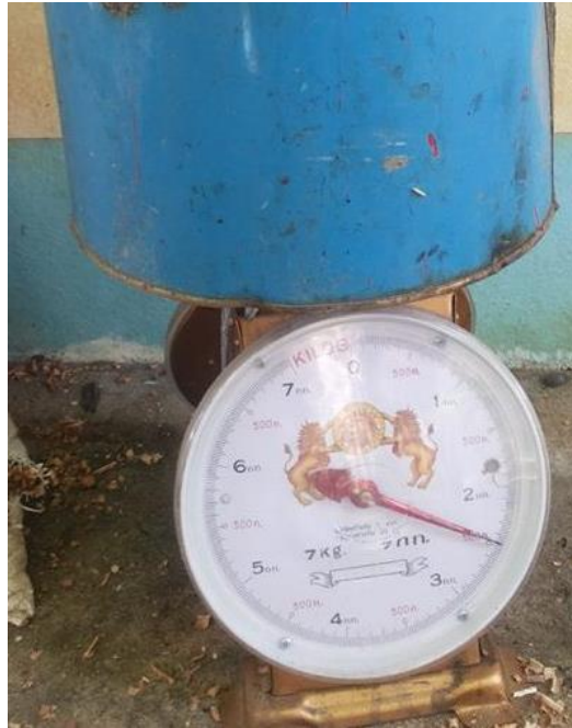
ภาพที่ 3.51 ภาพแสดงการชั่งน้ำหนักถ่านไม้ละเอียดปริมาณ 2 กิโลกรัม
