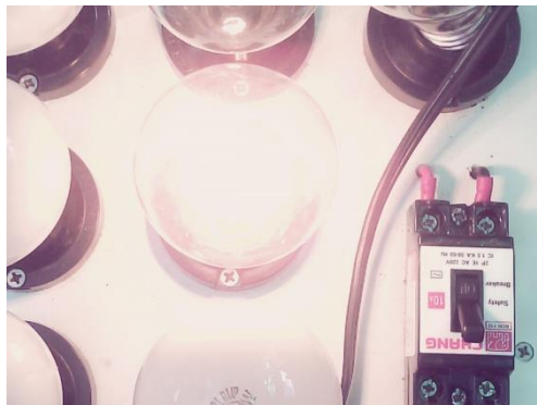
ภาพที่ 3.64 แสดงการทดสอบอุปกรณ์ไฟฟ้ากระแสสลับขนาด 100 วัตต์
