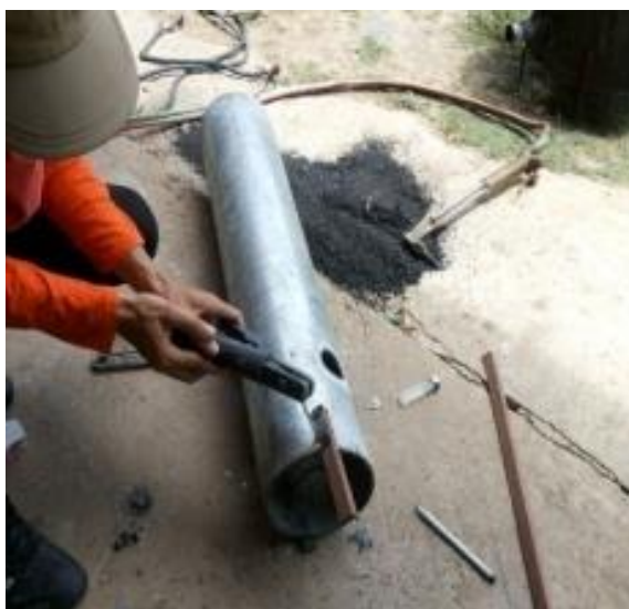
ภาพที่ 3.14 แสดงตำแหน่งที่เจาะรูห้องเผาชั้นใน
