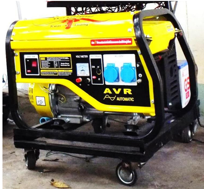
ภาพที่ 3.34 แสดงตำแหน่งการติดตั้งเครื่องปั่นไฟกับโครงสร้างชุดผลิตไฟฟ้า
