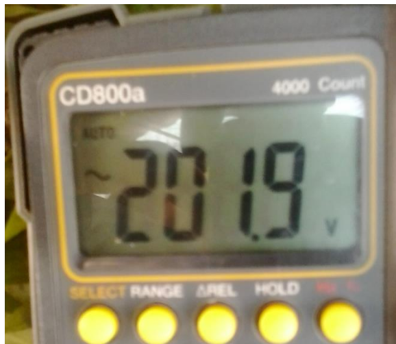
ภาพที่ 3.66 แสดงการใช้มัลติมิเตอร์วัดค่าแรงดันไฟฟ้ากระแสสลับ
