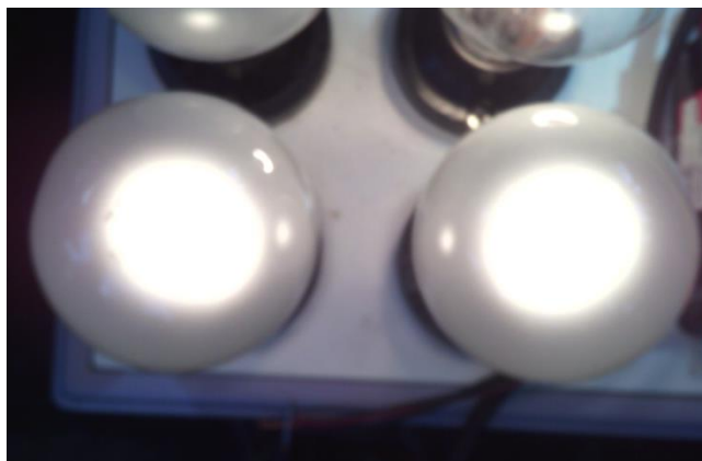
ภาพที่ 3.71 แสดงการทดสอบอุปกรณ์ไฟฟ้ากระแสตรงขนาด 100 วัตต์
