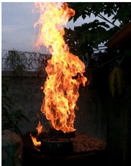
ภาพที่ 3.44 แสดงการทดสอบการเกิดแก๊สจากแกลบ
