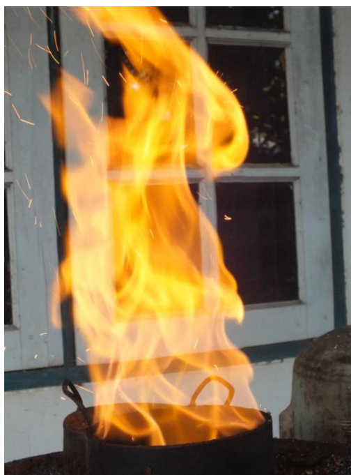
ภาพที่ 3.46 แสดงการทดสอบการเกิดแก๊สจากถ่านไม้
