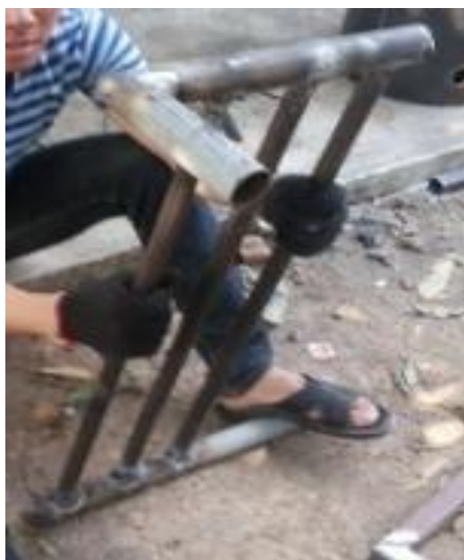
ภาพที่ 3.20 การประกอบท่อหล่อเย็น
