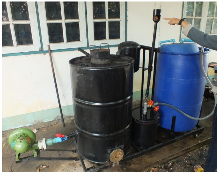
ภาพที่ 3.26 แสดงการประกอบชุดระบบต้นกำลังเตาแก๊สซีพีเออร์
