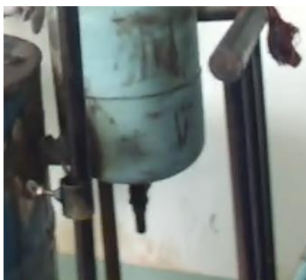
ภาพที่ 3.54 ภาพแสดงการตรวจเช็คแก๊สที่ถังกรองฝุ่นตะกอนและน้ำมันเตา
