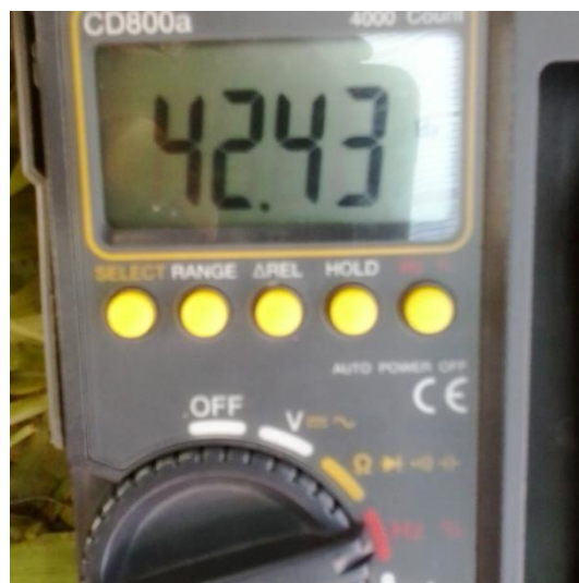
ภาพที่ 3.67 แสดงการใช้มัลติมิเตอร์วัดค่าความถี่ไฟฟ้ากระแสสลับ
