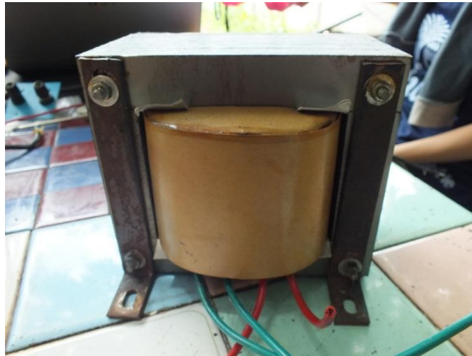
ภาพที่ 3.30 แสดงหม้อแปลงแรงดันขนาด 40 แอมแปร์
