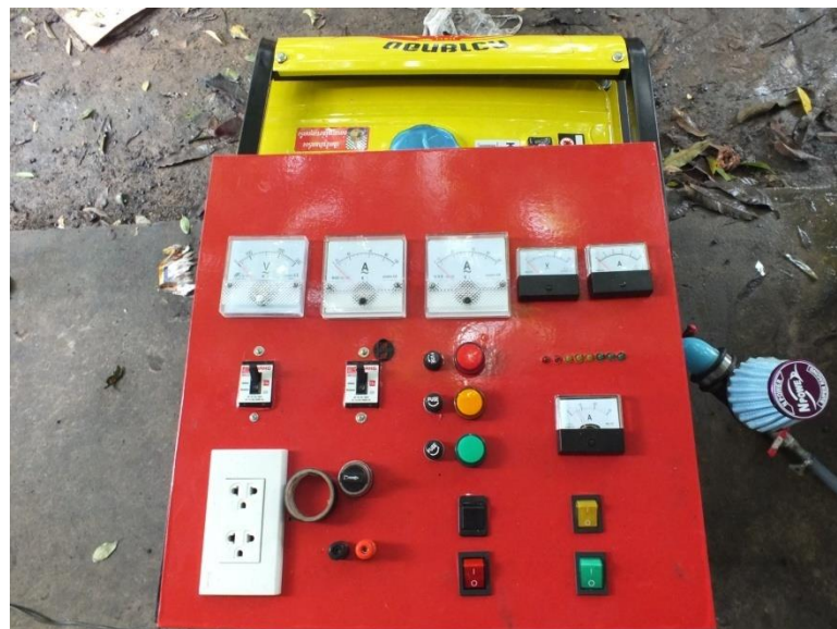
ภาพที่ 3.43 แสดงการติดตั้งแผงวงจรควบคุมและส่วนแสดงผลลัฟท์
