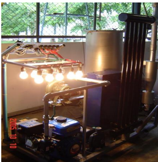
ภาพที่ 2.1 ระบบเครื่องแก๊สซิฟิเคชันและเครื่องยนต์ขนาดเล็กที่ใช้ผลิตไฟฟ้า ที่มา : www.manager.co.th ( สืบค้นเมื่อ 20 มีนาคม 2557).
