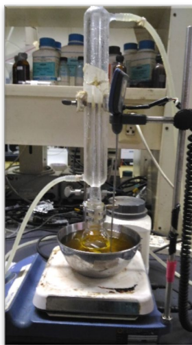
ภาพที่ 1 การทดลองการสังเคราะห์ 5-ไฮดรอกซีเมทิลเฟอฟูรัลในเครื่องปฏิกรณ์แบบกะ
