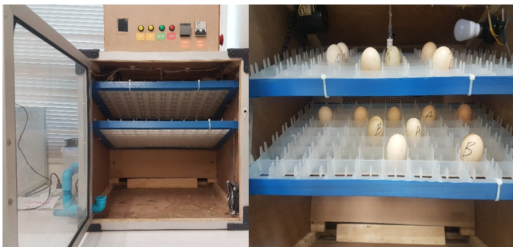
ภาพที่ 4 ตู้ฟักไข่แบบอัตโนมัติสำหรับไก่ชน
