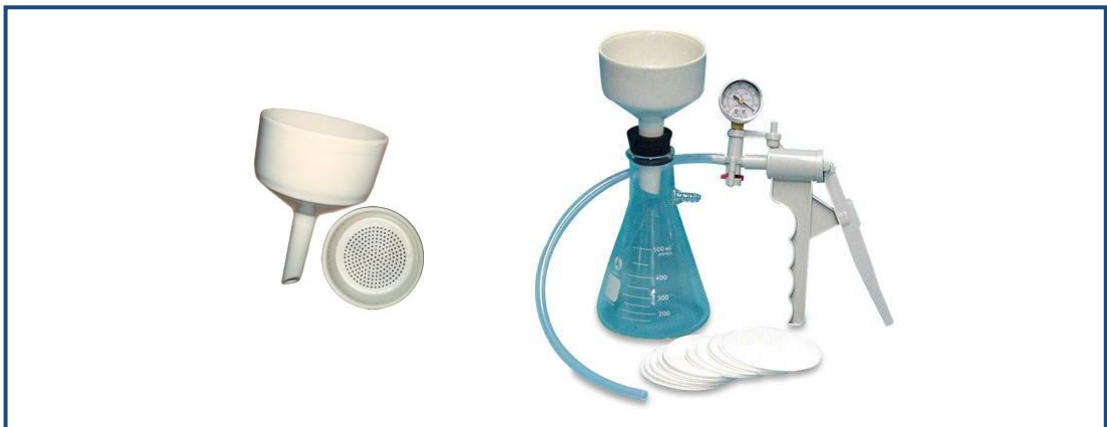
รูปที่ 2.18 กรวยบุชเนอร์และชุดกรองลดความดัน ที่มา : (Nasco, 2015)
