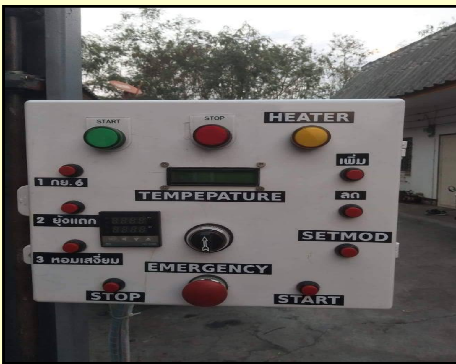
ภาพที่ 1 ส่วนประกอบของตู้ควบคุมเครื่องคว่ำข้าวเม่ากึ่งอัตโนมัติ
