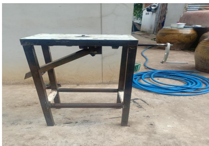
ภาพที่ 4.2 ผลการพัฒนาเครื่องจักตอกแปงสำหรับงานหัตถกรรมจักสานในครัวเรือน (ที่มา : พิชิต แก้วกล้า, 2562)
