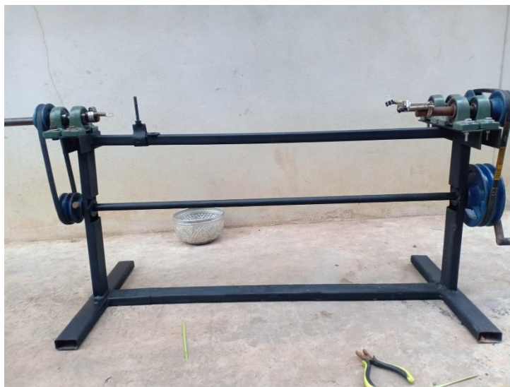
ภาพที่ 4.1 ผลการพัฒนาเครื่องปั่นแปงสำหรับงานหัตถกรรมจักสานในครัวเรือน (ที่มา : พิชิต แก้วกล้า, 2562)
