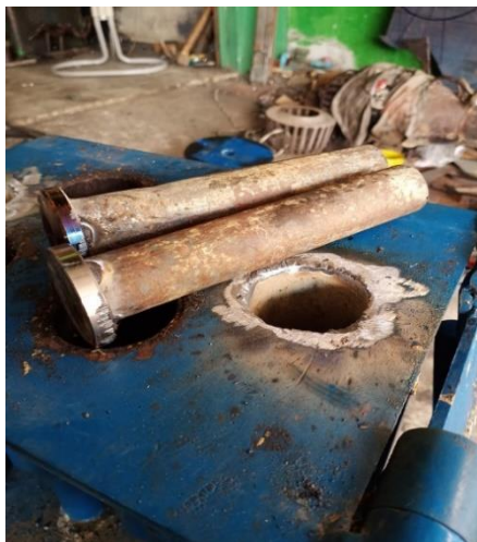
ภาพที่ 3.3 การจัดสร้างชุดครอบลูกสูบและลูกสูบ
