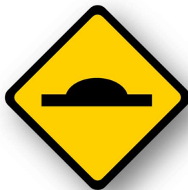
รูปที่ 2.7 ป้ายเตือนรถกระโดด ป้ายเตือนรถกระโดด
