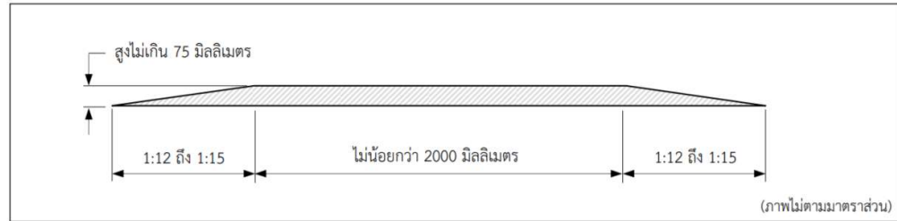
รูปที่ 2.6 รูปตัดและขนาดของเนินชะลอความเร็วแบบผิวบนแบนราบ (ประยุกต์จาก AS 1742.13-2009)
