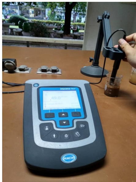
รูปที่ ก-6 การวัดค่า pH และ ค่าการนำไฟฟ้า
