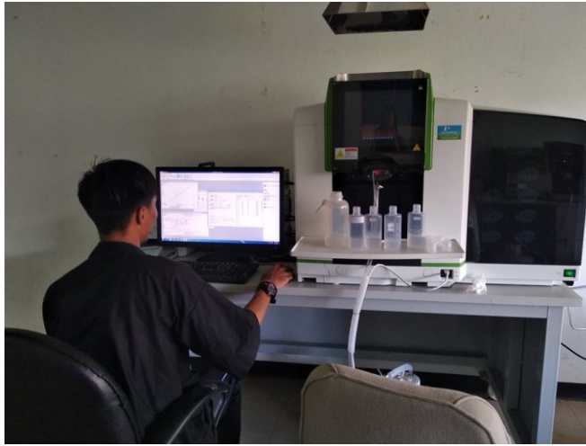
รูปที่ ก-7 ตรวจวัดหาปริมาณโลหะต้องห้ามในเครื่องสำอางในตัวอย่างดินด้วยเครื่อง AAS
