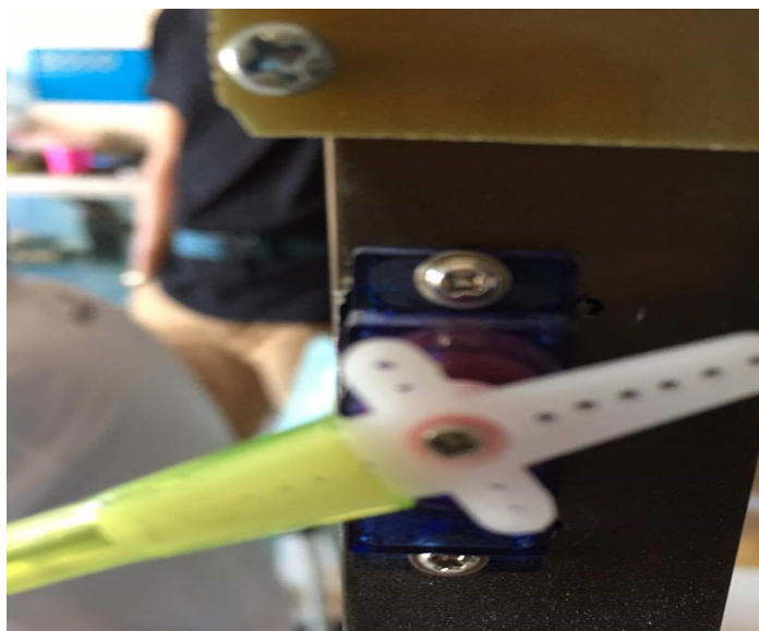
รูปที่ 3.16 ทำการติดตั้งเซอร์โวกับขาของตัวลำ
