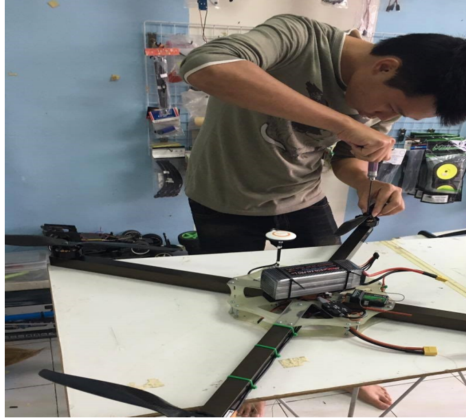
รูปที่ 3.11 ทำการติดตั้งมอเตอร์
