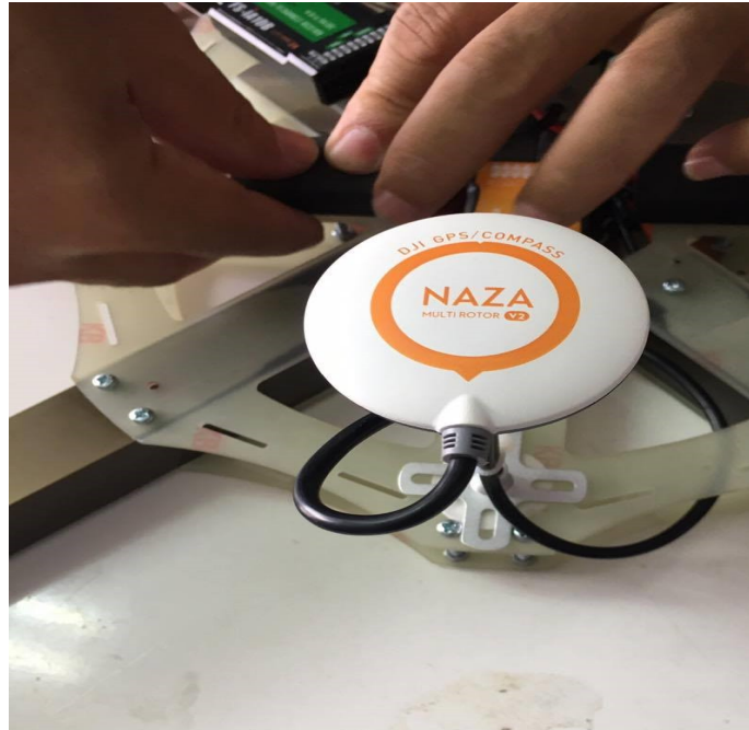
รูปที่ 3.9 ติดตั้ง GPS
