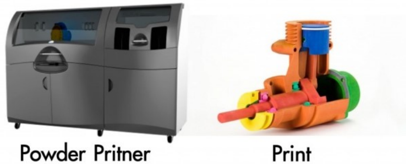
ภาพประกอบ 2.15 เครื่องพิมพ์ 3 มิติ ระบบผงยิปซัมสี Inkjet ที่มา : ปริ้นท์สามมิติ (2558 : 5)
