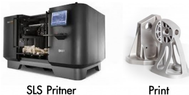
ภาพประกอบ 2.16 เครื่องพิมพ์ 3 มิติ ระบบหลอมผงพลาสติก ผงโลหะ หรือเซรามิก (SLS) ที่มา : ปริ้นท์สามมิติ (2558 : 6)
