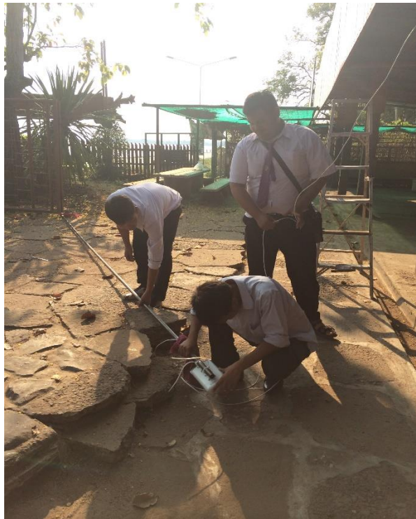
ภาพที่ 4.3 Internet Gateway Router รับ - ส่ง ข้อมูลระดับน้ำจากอุปกรณ์วัด มายังหน้าเว็บไซต์
