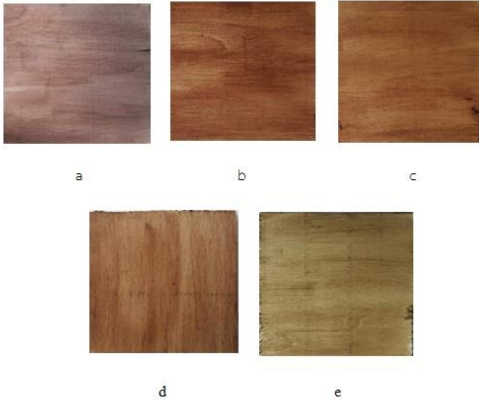
รูปที่ 8 ไม้อัดที่ทำด้วยสีจากดอกเฟื่องฟ้าและทาสารช่วยติด (a) ไม้ทาสารช่วยติด, (b) เกลือ, (c) สารส้ม, (d) ปูนขาว และ (e) คอปเปอร์ ซัลเฟต
