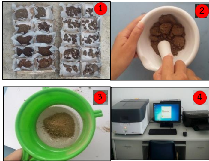
ภาพที่ 2 แสดงลักษณะของ (1) การตากดินให้แห้ง (2) การบดดินให้ละเอียด (3) ร่อนดินผ่านตะแกรงขนาด 2 mm (4) การวิเคราะห์ด้วยเครื่องEDXRF
