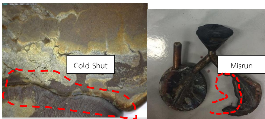
รูปที่ 8 การเกิด Cold shut และ Misrun บนชิ้นงาน
