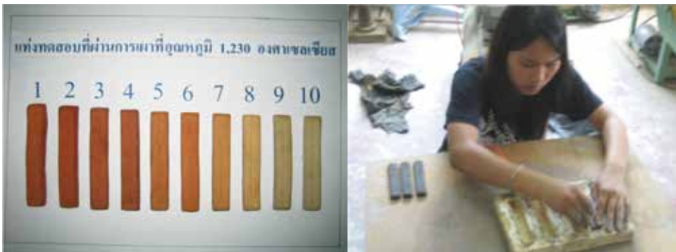
ภาพที่ 1 การอัดเป็นแท่งทดสอบ และแท่งทดสอบเนื้อดินหลังเผาแกร่ง
