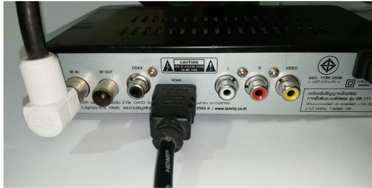
ภาพที่ 3.14 การต่อสัญญาณ HDMI จาก Set Top Box ไปยังเครื่องรับโทรทัศน์
