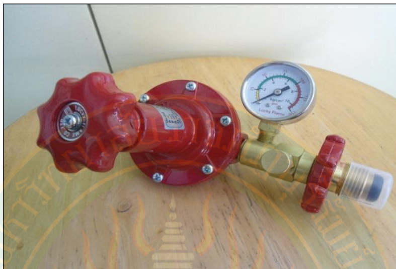
ภาพประกอบ ข 13 วาล์วแก๊สพร้อมติดมาตรวัดความดัน
