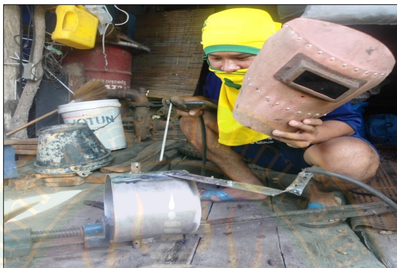
ภาพประกอบ ค 3 เชื่อมถังของเครื่องผลิตน้ำมันไบโอดีเซลจากน้ำมันพืชที่ใช้แล้ว
