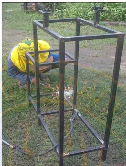
ภาพประกอบ ค 1 เชื่อมฐานของเครื่องผลิตน้ำมันไบโอดีเซลจากน้ำมันพืชที่ใช้แล้ว
