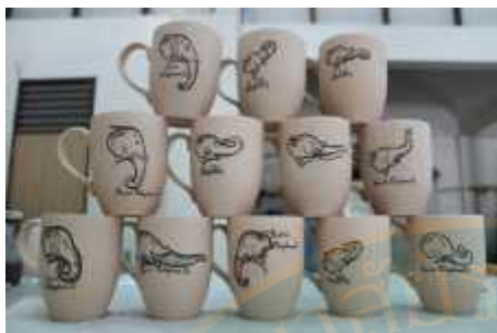
ภาพที่ ๕ งานตกแต่งด้วยการเขียนสีได้เคลือบ เคลือบและเตรียมเผาเคลือบ
