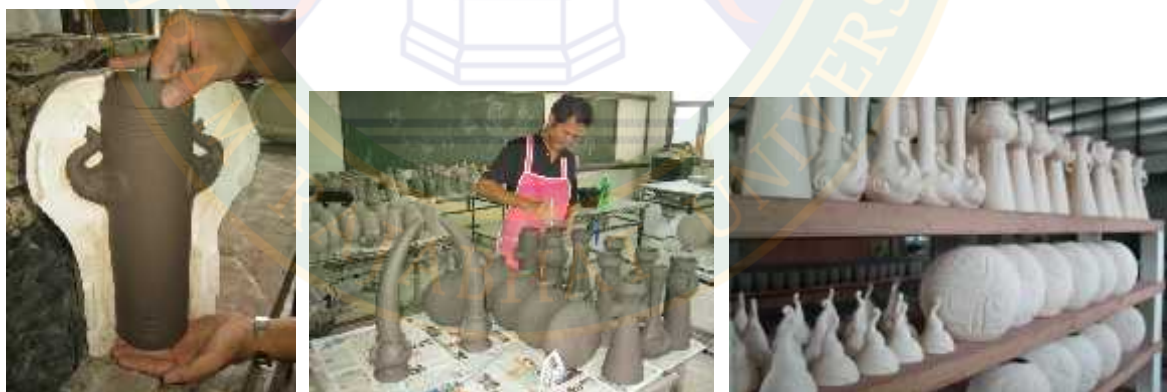
ภาพที่ ๔ ชิ้นงานที่ขึ้นรูปด้วยวิธีการหล่อ ตกแต่งเก็บรายละเอียด และชิ้นงานหลังเผาดิบ
