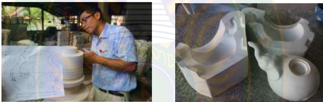
ภาพที่ ๓ การกลึงต้นแบบ และการทำพิมพ์ชุดน้ำ
