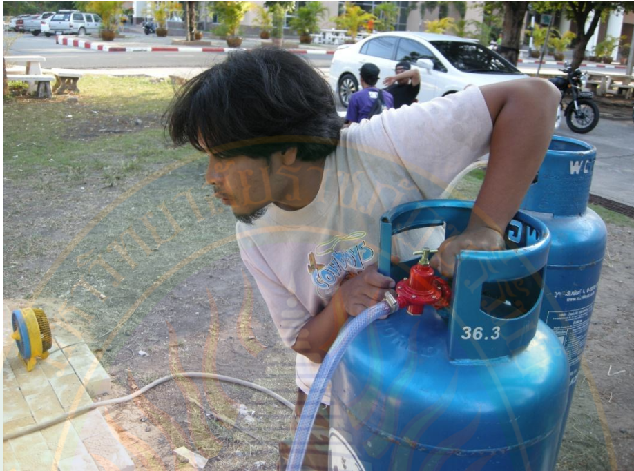
ภาพที่ 44 ตรวจสอบแรงดันของแก๊ส
