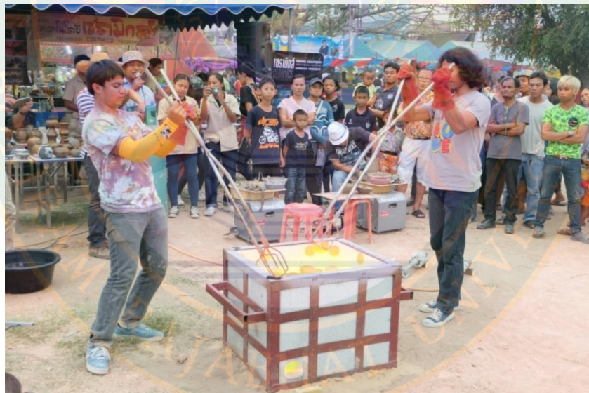
ภาพที่ 103 การคีบชิ้นงานออกจากเตาเผาในขณะที่ชิ้นงานกำลังร้อน
