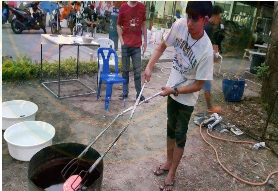
ภาพที่ 69 เมื่อรมควันแล้วคืบชิ้นงานลงน้ำ
