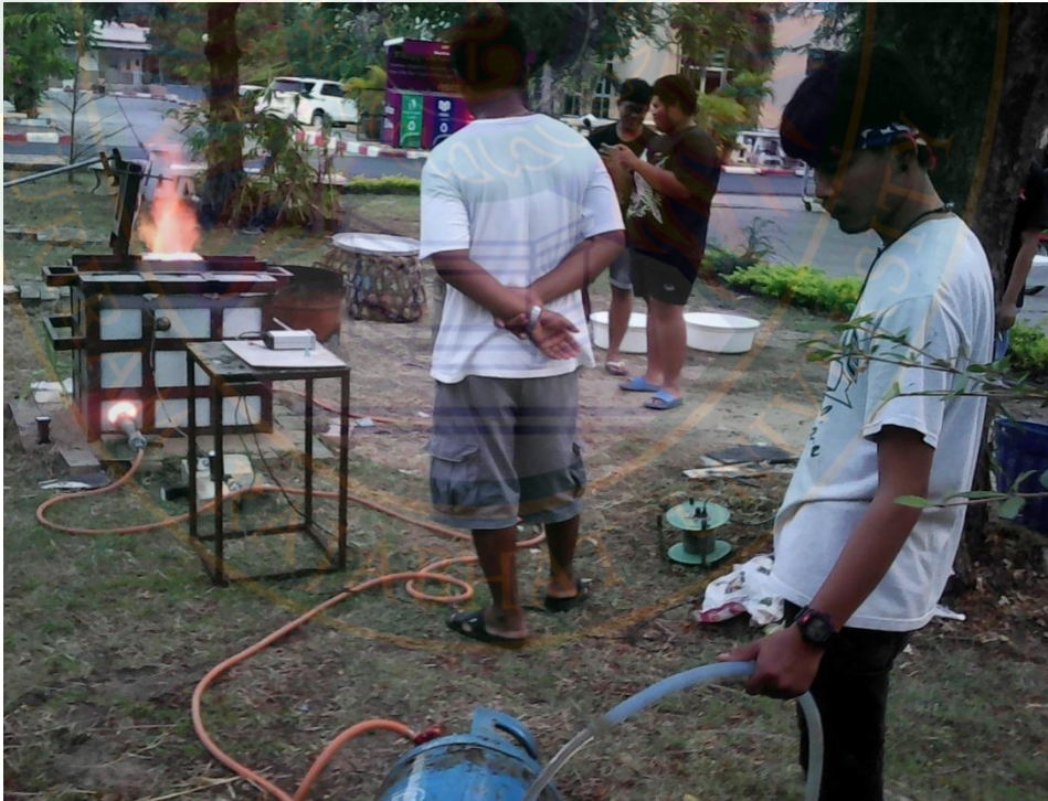
ภาพที่ 51 เวลาผ่านไป 2 ชั่วโมง อุณหภูมิจะอยู่ที่ 1,100 องศาเซลเซียส
