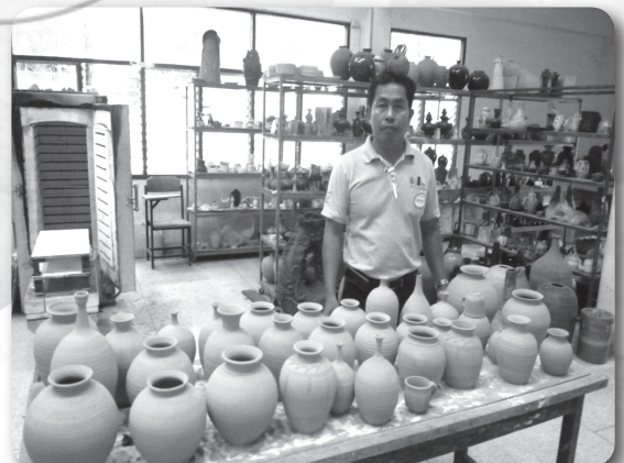
ภาพที่ 4 ผลิตภัณฑ์จากการขึ้นรูปแบบอิสระ และแบบแป้นหมุนที่อุณหภูมิ 1,000 องศาเซลเซียส
