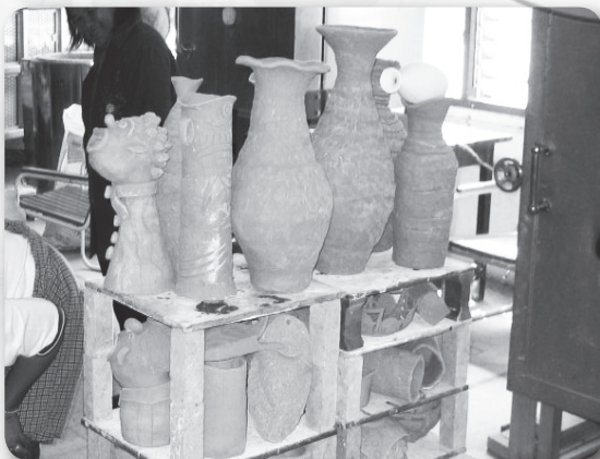
ภาพที่ 4 ผลิตภัณฑ์จากการขึ้นรูปแบบอิสระ และแบบแป้นหมุนที่อุณหภูมิ 1,000 องศาเซลเซียส
