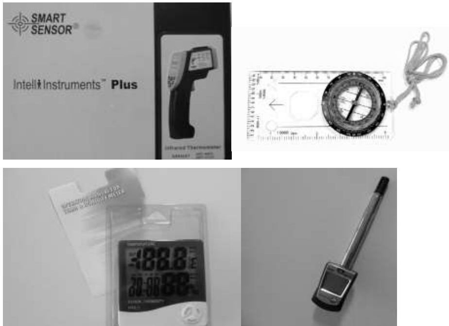
ภาพที่ 3.5 เครื่องมือทางวิทยาศาสตร์ ได้แก่ เทอร์โมมิเตอร์ เซ็มทิส ไฮโกรมิเตอร์ และแอนีโมมิเตอร์
