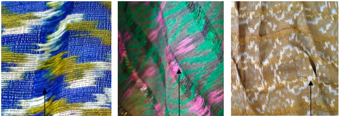
ส่วนที่เส้นด้ายพุ่งหย่อน เนื่องจากไม่มีเส้นด้ายยืนมาทอขัด โครงสร้างผ้าเสียหาย ทำให้ลายเกิดความพร้าเลือน
